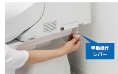
便器の右側に格納している手動レバーを引っ張ることで、停電の時でも水を流します(乾電池は不要です)
